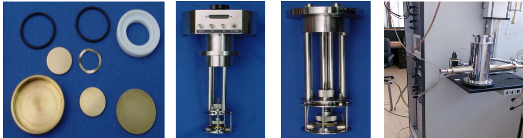
Fig.2 Celule de masură ale dielectricilor lichizi, celule active de măsură, și sistemul de control al temperaturii
